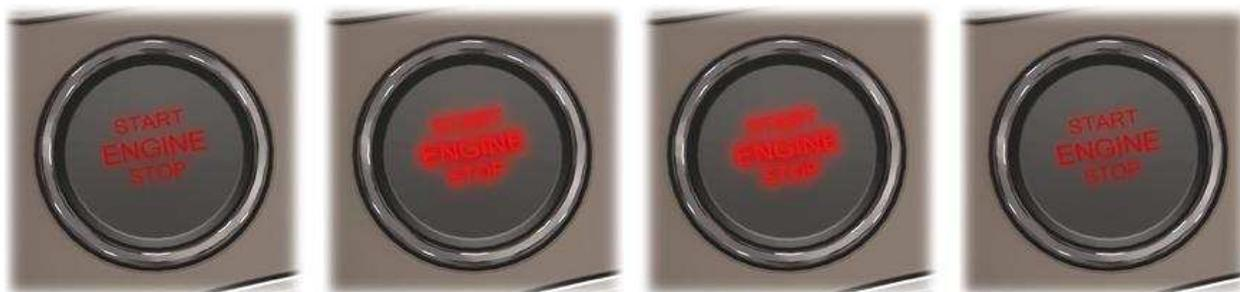
FUNCIÓN HEART BEAT: Secuencia de aviso al conductor para arrancar el motor mediante el Pulsador del dispositivo de arranque E378
